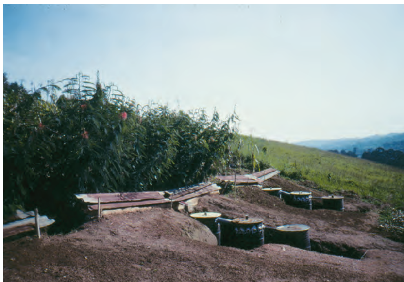
Dispositif de mesure du ruissellement et de l'érosion à la station de Rubona sur une pente de 28 % aménagée en terrasses progressives grâce à des haies de Calliandra calothyrsus .
